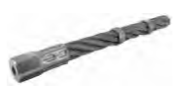
Wildkrautbüschel Seilwickeldraht Ø 22 mm. Gesamtlänge: 300 mm. M12 Gewinde
